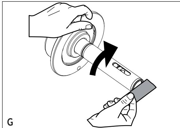
*Si raccomanda tassativamente la verifica periodica (mensile) del corretto serraggio del terminale SE2 (780N m 575Ft lbs). Un serraggio errato può provocare imprecisioni di equilibratura e danni alla macchina NON COPERTI DA GARANZIA.*
